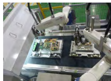
PETECKの薄型テレビネジ外し作業自動化装置
