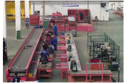
新会社のテレビ解体ライン
