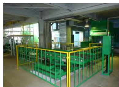
PETECのシクロペンタン専用破碎選別ライン
